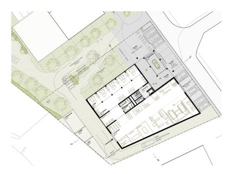
Im zweiten Bauabschnitt (Zeitpunkt des Baus noch nicht terminisiert) kann auf insgesamt 8 Geschoße aufgestockt werden. Ein Kellergeschoß ist nicht vorgesehen. Das Erdgeschoß besteht dabei aus einem Technikum mit typischen Holzbearbeitungsanlagen und Handarbeitsplätzen. Die darüber angeordneten Geschoße beinhalten Büroflächen.
